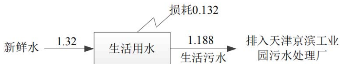
图1 项目水平衡图（单位： \text{m}^3/\text{d} ）
